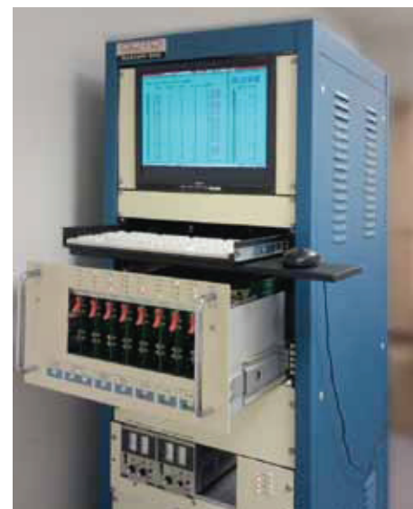
Рисунок 2. Система тестирования срока службы реле Coto Technology 300
