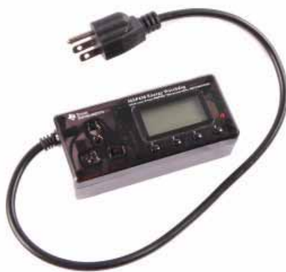
Рисунок 1. Типовая конструкция «умного» штепселя MSP430™ Energy Watchdog2
