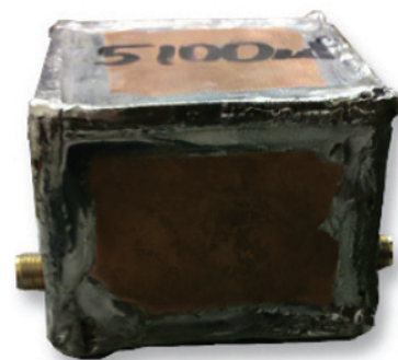
Рисунок 3. Экранированный конденсатор на 5100 мкФ для измерения шумов низкого уровня
