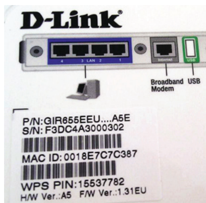
Рисунок 1. Например, PIN-номер WPS напечатан на точке доступа D-Link® (слева), а кнопка подключения WPS находится на точке доступа Cisco (справа)
