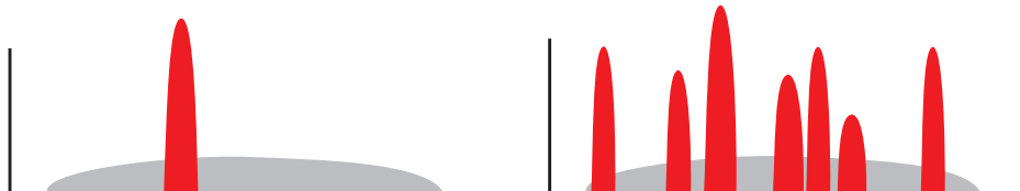
Рисунок 2. Широкополосная система с кодированием и узкополосная помеха
