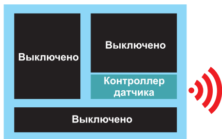
Рисунок 3. Сложное управление питанием в некоторых беспроводных МК сети Sub-1 GHz может отключать большую часть узла с датчиком, чтобы батарейки-таблетки могли служить до 10 лет
