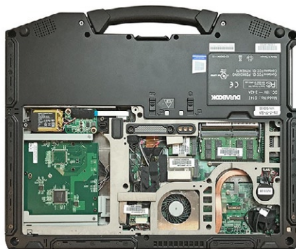
Рисунок 5. Вид снизу. Расположение компонентов внутри корпуса ноутбука Durabook S14I
